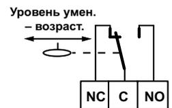
СХЕМА СОЕДИНЕНИЙ ДЛЯ НАСОСА ОПОРОЖНЕНИЯ
